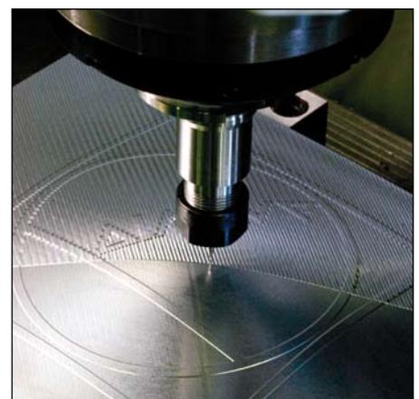
Unter dem Begriff **Dynamic Precision** sind optionale Funktionen für HEIDENHAIN-Steuerungen zusammengefasst, die die dynamischen Fehler von Werkzeugmaschinen wirkungsvoll reduzieren. Sie verbessern das dynamische Maschinenverhalten, erzielen eine höhere Steifigkeit am TCP und ermöglichen so das Fräsen an der Grenze des technologisch Möglichen unabhängig vom Alter der Maschine, ihrer Beladung und der Bearbeitungsposition.
